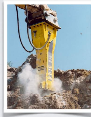
На небольших щебеночных карьерах используется 2 основных метода добычи горной массы: это взрывной метод и добыча с помощью гидромолотов, остальные методы (рыхлители, виброрыхлители, фрезы, горные комбайны, электрогидравлические взрыватели) имеют узкое применение и крайне сомнительный экономический эффект.
